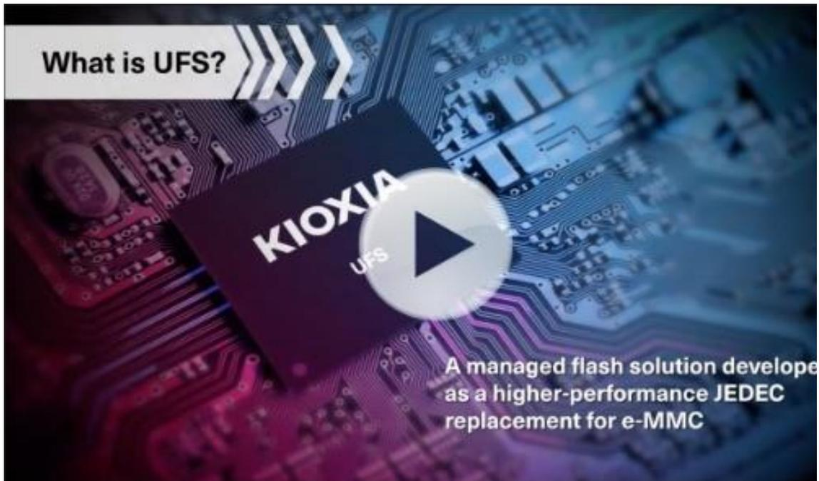
Une autre innovation intéressante est la mémoire flash embarquée version [3.1 UFS 1 To de KIOXIA](#). C'est l'appareil UFS le plus simplifié du marché doté de cette capacité de stockage, car il peut s'insérer dans un format d'emballage de seulement 1,1 mm de hauteur. En utilisant la technologie innovante BiCS FLASH™ 3D de la société, des vitesses de lecture séquentielle allant jusqu'à 2050 Mo/s et des vitesses d'écriture séquentielles allant jusqu'à 1200 Mo/s peuvent être atteintes.
